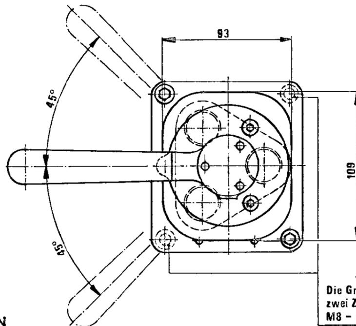
Die Grundplatte wird am Führerstand mit zwei Zylinderschrauben mit Innensechskant M8 - DIN 6912 - befestigt
